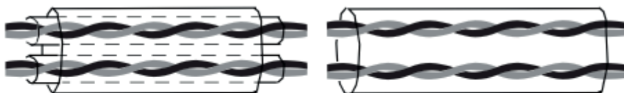
а Кабель с витыми парами и двойным экраном
