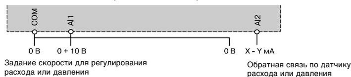
Схема соединений с обратной связью через A13
