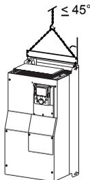
Преобразователи ALTIVAR 71 до типоразмеров ATV71HD15M3X и ATV71HD18N4 могут быть распакованы и установлены без вспомогательных средств.
