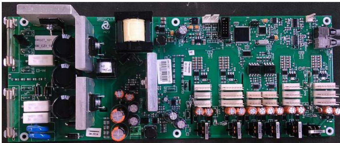
Рисунок 3.31 — Блок контроллера ячейки
