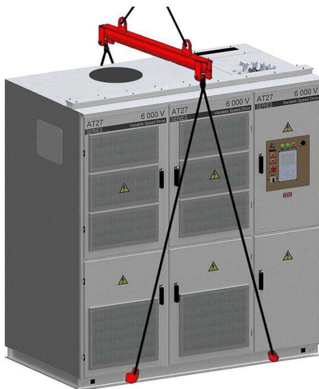
Рисунок 6.2 — Стрповка моношкафа AT27-M32...M32
