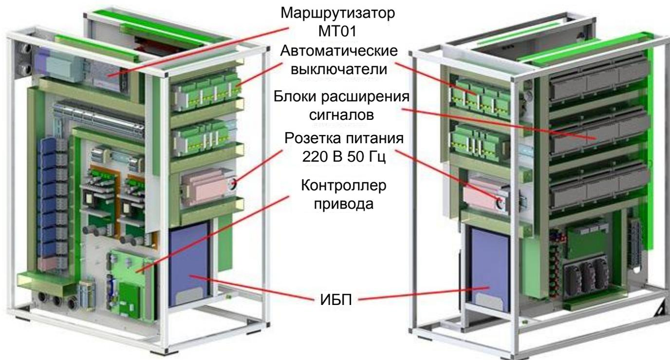
**Рисунок 3.43 — Оборудование отсека управления**
