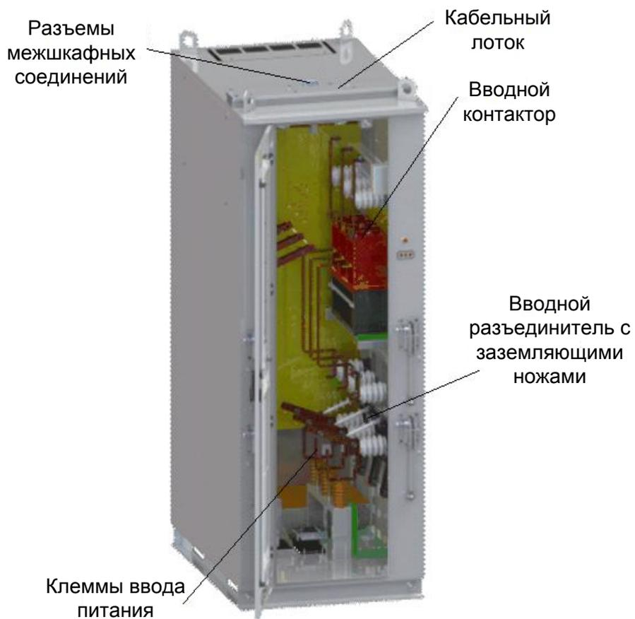
Рисунок 3.17 — Вводной контактор и разъединитель с заземляющими ножами
