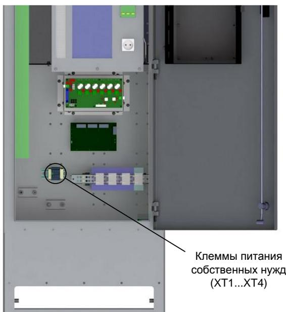
Рисунок 7.4 — Клеммы питания собственных нужд в ШУ
