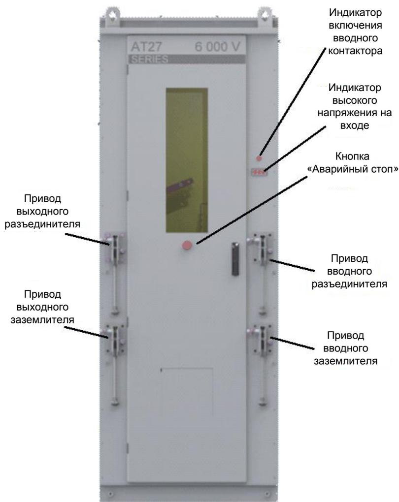
**Рисунок 3.20 — Расположение органов управления ШВ**
