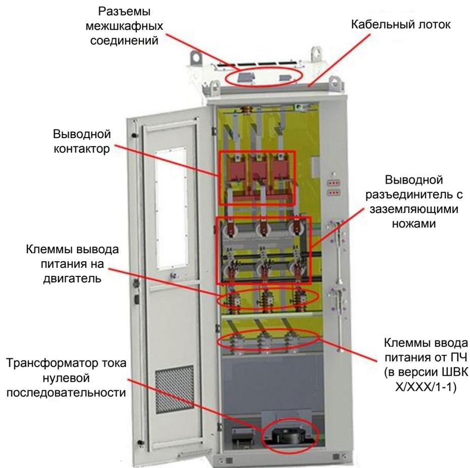
Рисунок 3.22 — Выводной контактор и разъединитель с заземляющими ножами
