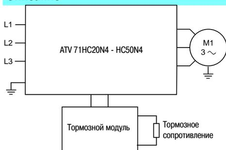
Торможение на сопротивление позволяет преобразователю Altivar 71 обеспечить остановку или работу электропривода в генераторном режиме, рассеивая энергию на этом сопротивлении.
