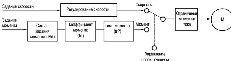
Момент задается со знаком и с собственным темпом разгона. Коэффициент момента позволяет отмасштабировать задание. Оно может быть передано с помощью аналогового или импульсного входа (вход RP или импульсный датчик) или по коммуникационной сети. Знак и величина момента могут быть отображены с помощью дискретного или аналогового выхода.
