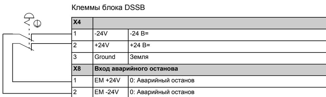
**Примечание.** Клеммы платы DSSB подключены к отдельной клеммной колодке, на которой производятся соединения, выполняемые пользователем. См. схемы, входящие в комплект поставки блока.
