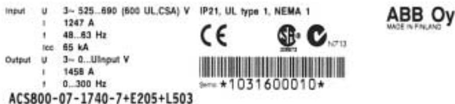
Каждый силовой модуль (т.е. каждый модуль питания и модуль инвертора) также имеют индивидуальную маркировку.
