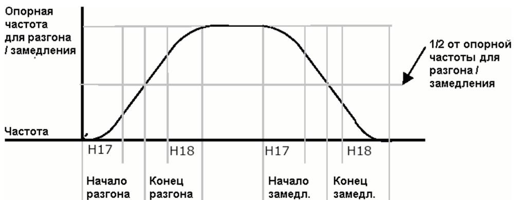
Следует иметь в виду, что при использовании максимальной частоты в качестве опорной для разгона / замедления (H70), и при частоте задания ниже максимальной форма кривой разгона может быть искажена.
