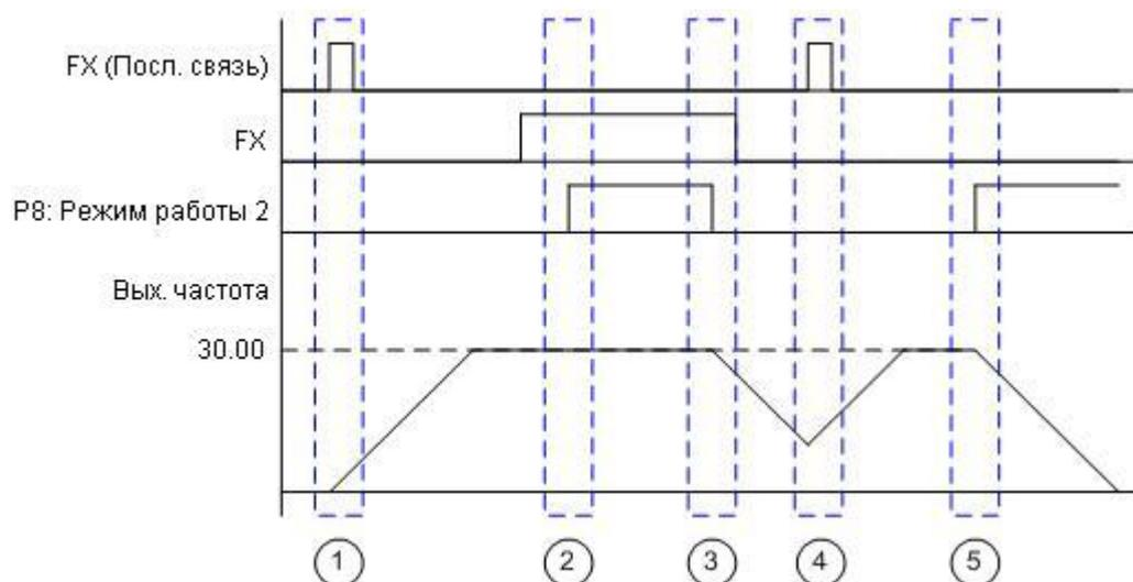
1. Разгон до заданной частоты в режиме работы 1 по сигналу FX
