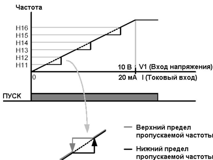
При необходимости избежать резонанса, связанного с собственной частотой механической системы, нужно исключить работу на частотах, близких к частоте резонанса. Имеется возможность установки трех диапазонов пропускаемых частот. Однако при разгоне и замедлении работа на пропускаемых частотах допустима.
