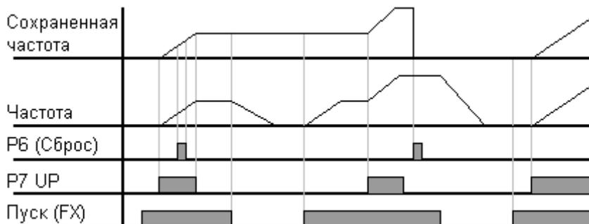
При F65 = 1: Задание частоты увеличивается на величину F66 по переднему фронту сигнала на входе UP и запоминается по заднему фронту. Аналогично задание уменьшается при подаче сигнала на вход DOWN. В этом случае при наличии сигналов на входах UP/DOWN и при подаче команды на останов запоминается значение задания, имевшее место при последнем заднем фронте сигналов на этих входах.
