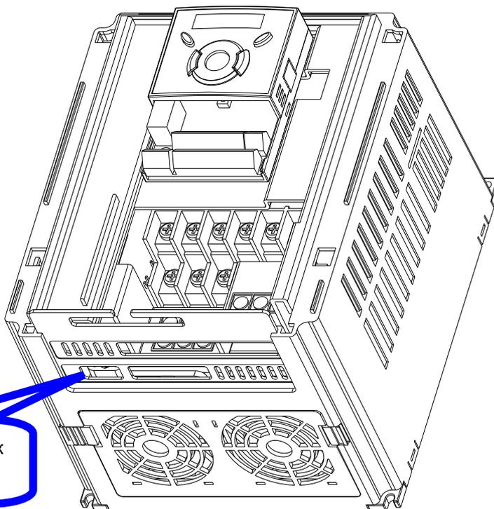
Открыть для доступа к клемме заземления
