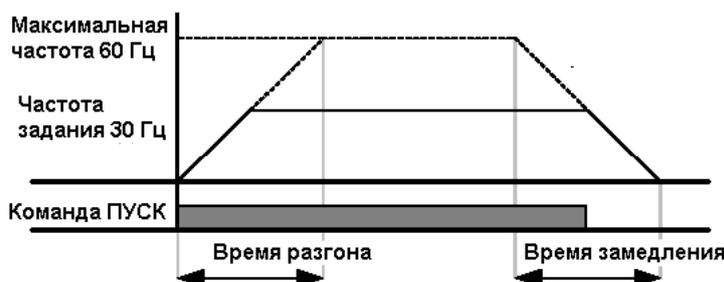
При различных нагрузках возможно изменение единиц времени, как показано ниже. В моделях Sinus M на дисплее 5 цифр, поэтому при единице 0.01 с можно установить максимальное время разгона 600.00 с.
