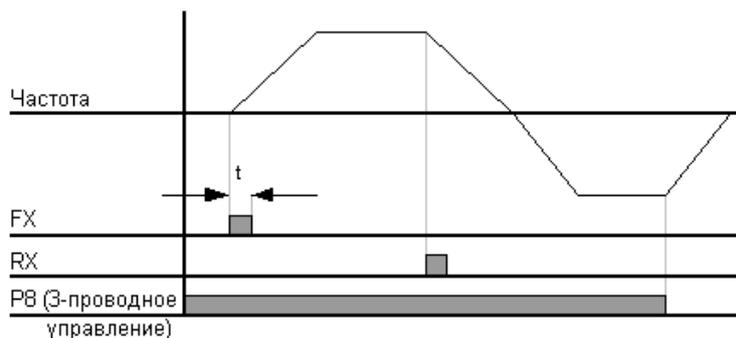
При трехпроводном управлении входной сигнал запоминается.
