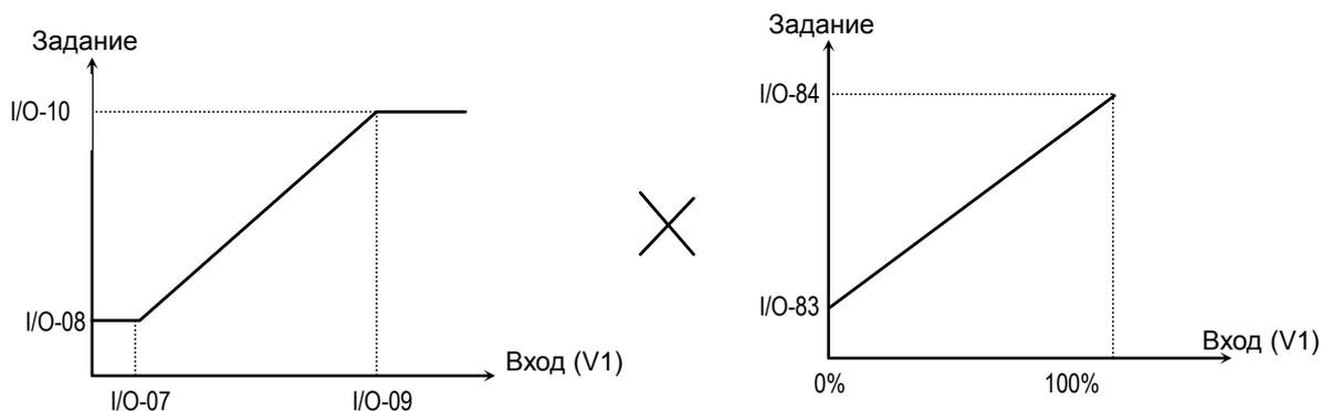
$$FBK = \left( \left( \frac{I10 - I8}{I9 - I7} \right) \times (\text{Входное напряжение} - I7) + I8 \right) \times \frac{(I90 - I89)}{\text{Макс.Частота}} + I89 \text{ при сигнале ОС от V1}$$
