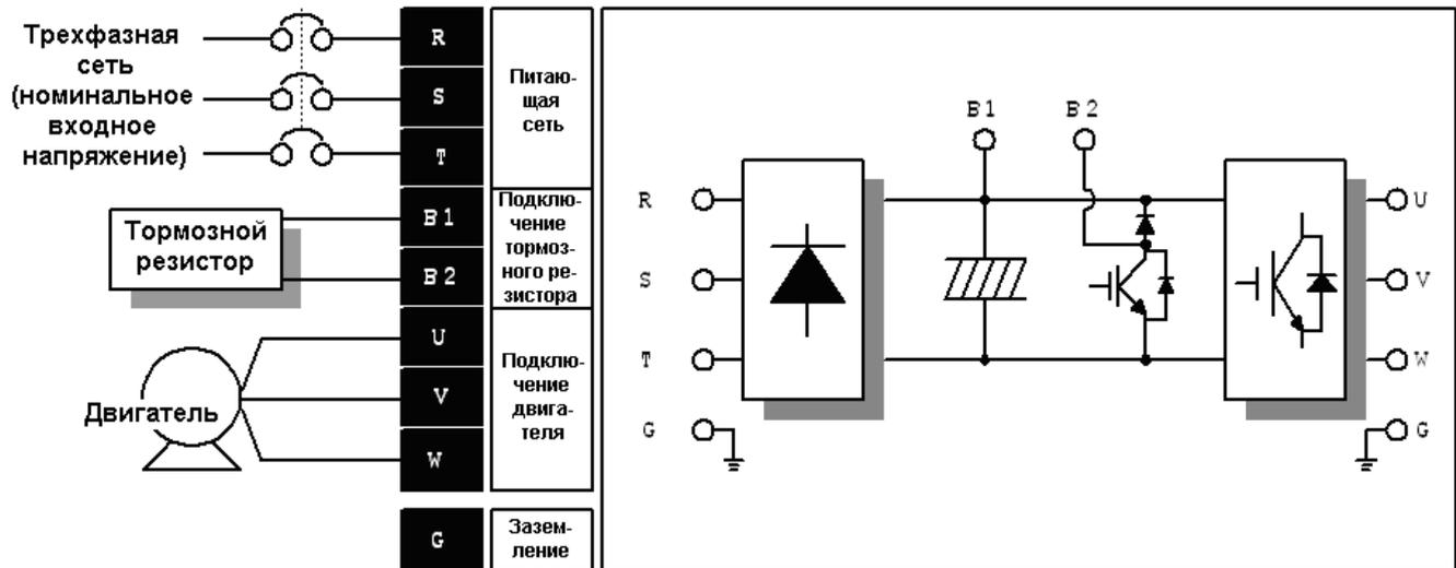
\* Модели 2S/T должны подключаться к однофазной сети через клеммы R, T.
