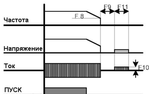
При использовании торможения постоянным током в механизмах с большим моментом инерции и на высокой частоте измените коэффициент регулятора торможения (параметр H37).
