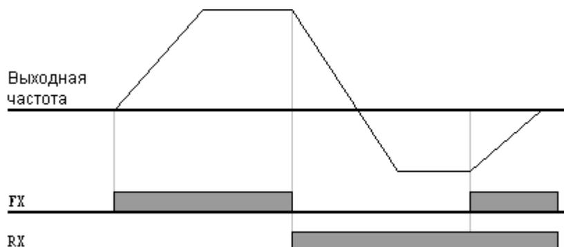
● Пуск и останов через клеммы FX и RX (режим 2)
