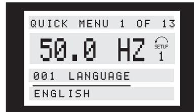
Внизу дисплея показываются номер и наименование параметра; также показывается состояние значения первого параметра быстрой настройки. При первом после включения блока нажатии клавиши [Quick Menu] вывод данных на дисплее всегда начинается с поз. 1 (см. приведенную ниже таблицу).
