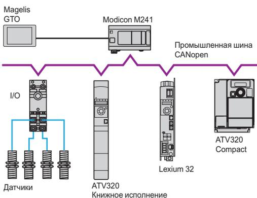
Пример конфигурации с использованием шины CANopen
