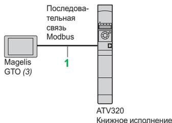
Пример подключения преобразователя частоты Altivar 320 книжного исполнения к панели Magelis GTO с использованием последовательного соединения Modbus
