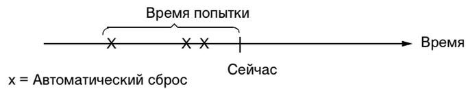
*Рисунок 13 Срабатывание функции автоматического сброса. В данном примере, если сбой происходит в момент "Сейчас", то он автоматически сбрасывается в том случае, если значение параметра 3101 КОЛИЧЕСТВО ПОПЫТОК превышает 3.*
