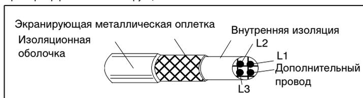
Рис. 21 Эффективное экранирование кабеля электродвигателя (например, кабели Цiflex-Servo-FD 780 CP, Lappkabel или МССМК, НК).
