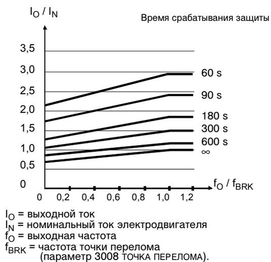
Рис. 12 Значения времени срабатывания защиты от перегрева, когда параметры 3005 ТЕПЛОВАЯ ПОСТОЯННАЯ ЭЛЕКТРОДВИГАТЕЛЯ, 3006 НАГРУЗОЧНАЯ ХАРАКТЕРИСТИКА ЭЛЕКТРОДВИГАТЕЛЯ и 3007 НАГРУЗКА ПРИ НУЛЕВОЙ СКОРОСТИ имеют значения по умолчанию.
