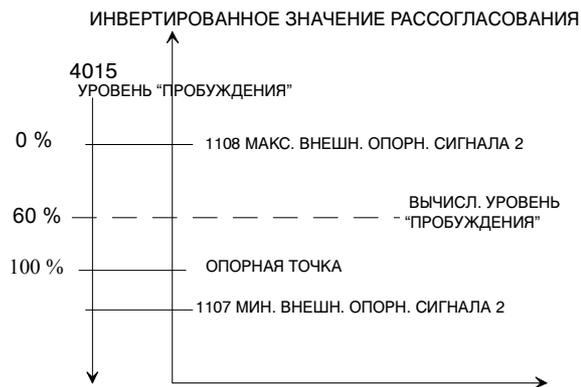
*Рисунок 19 Пример изменения уровня “пробуждения”, плавающего с опорной точкой, значение параметра 4015 уровень “пробуждения” равняется 60 %, вариант инвертированного ПИД регулирования.*
