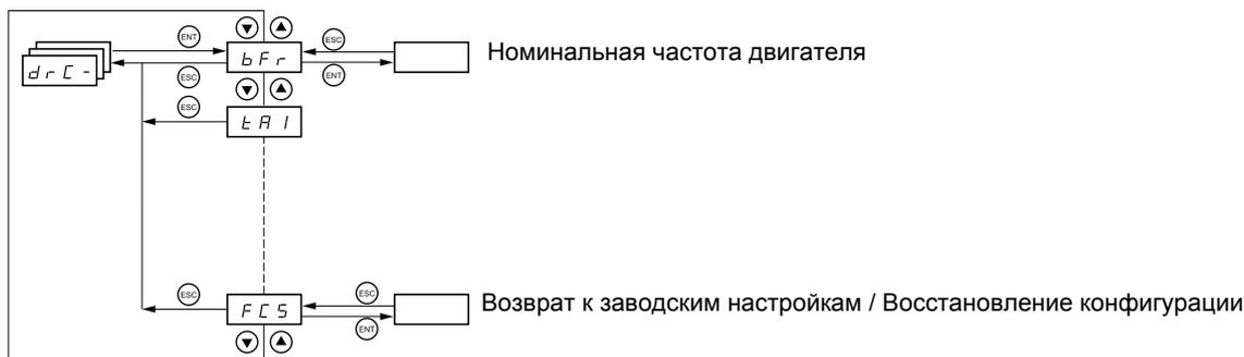
Параметры настраиваются только при остановленном двигателе и отсутствии команды пуска, кроме параметра tUn, который может привести к подаче напряжения на двигатель.
