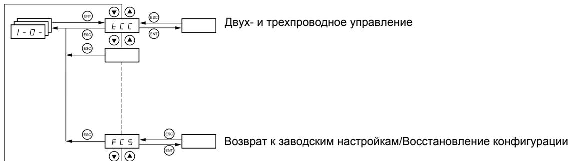
Параметры настраиваются только при остановленном двигателе и при отсутствии команды пуска.
