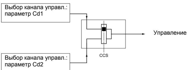
Параметр CCS позволяет выбрать канал Cd1 или Cd2 или сконфигурировать дискретный вход или бит слова управления для дистанционного переключения с одного канала на другой.
