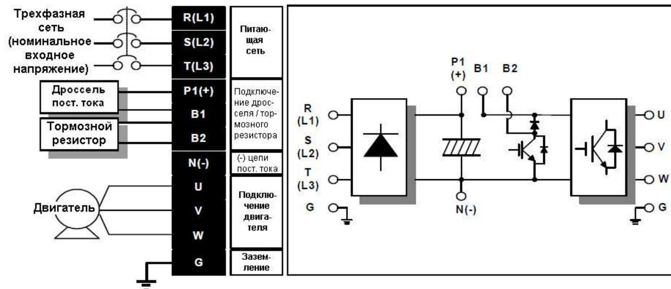
\* Модели 2S/T должны подключаться к однофазной сети через клеммы R, T.
