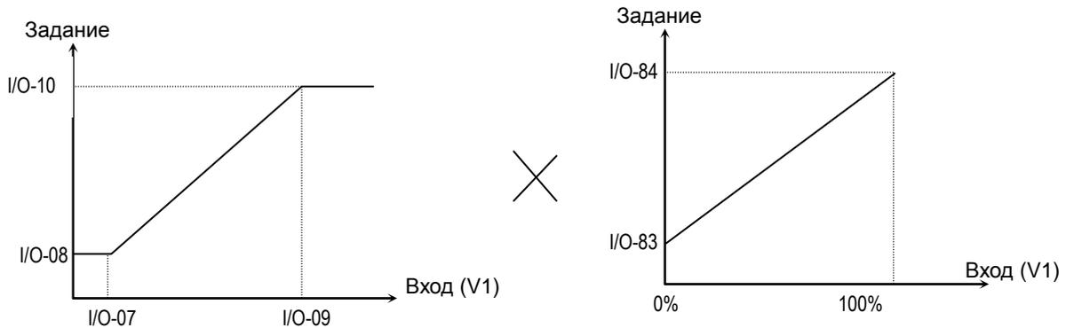
$$FBK = \left( \left( \frac{I10 - I8}{I9 - I7} \right) \times (\text{Входное напряжение} - I7) + I8 \right) \times \frac{(I90 - I89)}{\text{Макс. Частота}} + I89 \text{ при сигнале ОС от V1}$$
