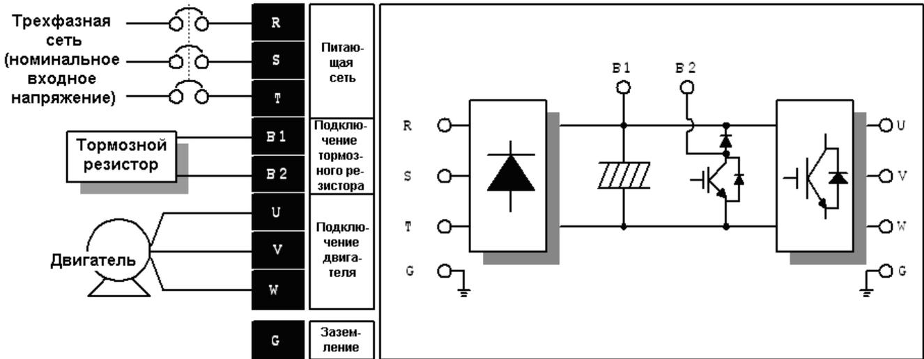
\* Однофазное подключение для моделей 2S/T выполняется к клеммам R, T
