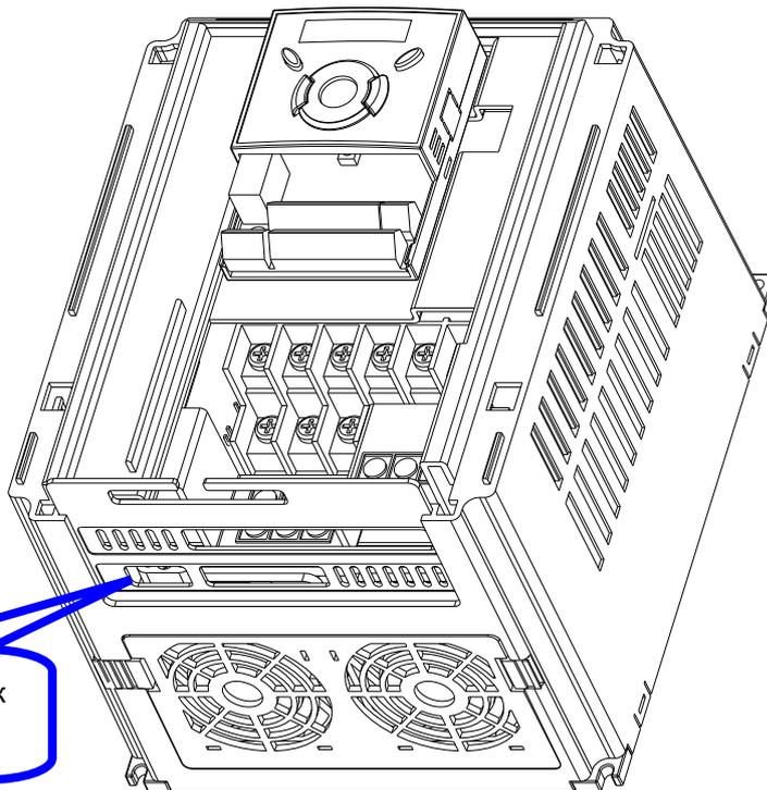
Открыть для доступа к клемме заземления
