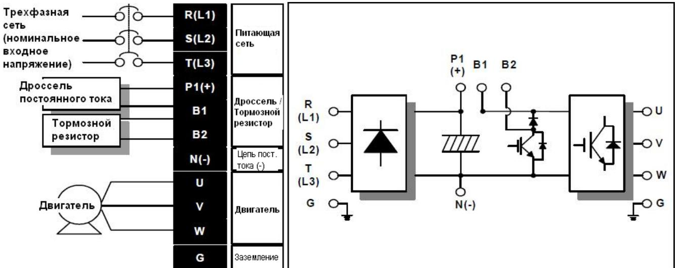
\* Однофазное подключение для моделей 2S/T выполняется к клеммам R, T
