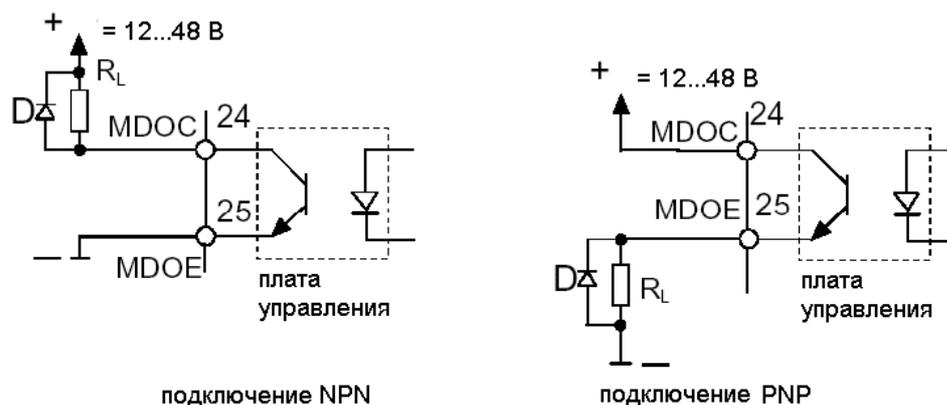
Рис. 1.2 – Подключение реле к выходу с открытым коллектором
