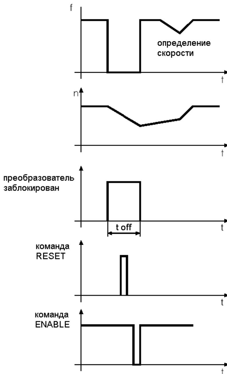
Рис. 3.6 – Выходная частота, скорость, блокировка преобразователя, команды RESET и ENABLE в процессе определения скорости при аварийном отключении ( $C55 = [YES]$  или  $C55 = [YES A]$ ).  $t_{OFF} < t_{SSdis}$  ( $C56$ ) или  $C56 = 0$ .
