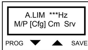
7) Если выходная частота (ПО IFD) или скорость (ПО VTC) постоянна при замедлении из-за ограничения тока (ПО IFD) или момента (ПО VTC):
