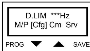
8) Если выходная частота (ПО IFD) или скорость (ПО VTC) ниже заданной из-за ограничения тока (ПО IFD) или момента (ПО VTC) во время работы на постоянной частоте:
