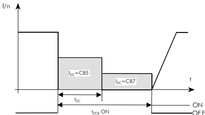
Рис. 3.13 – Выходная частота и ток торможения при активности функции включения тока удержания
